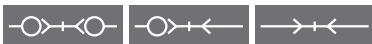
Male long thread socket with 24° sealing cone / Kupplung mit langem Aussengewinde 24° Dichtkonus
